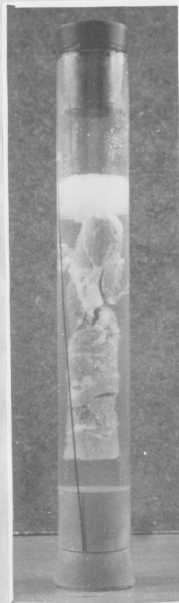
Abb. 3. Die mit dem Gelée und Paraffin übergossene im Glaszylinder befindliche Probe
