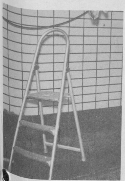
4. Ladder with non-skid rubber steps. Treppe mit gleitsicheren Stufen. Лестница с резиновыми ступенями Trapp med sklisisikre trinn.
