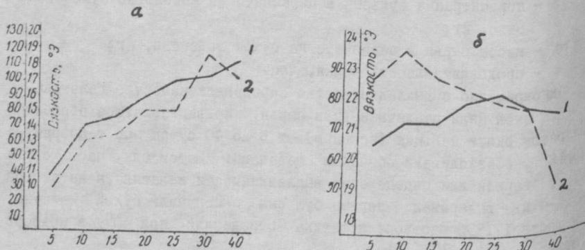
График зависимости выплавляемости и вязкости желатина от продолжительности процесса золения при переработке:
