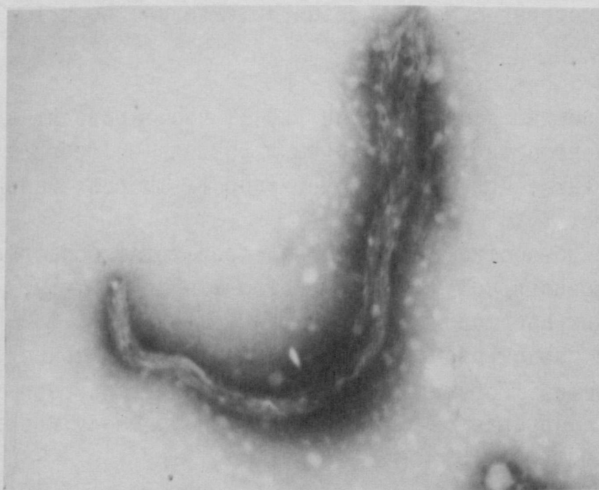
Рис. 4. Электронная микрофотография оссеина после 48-часовой щелочно-солевой обработки. Увеличение \times 75000
