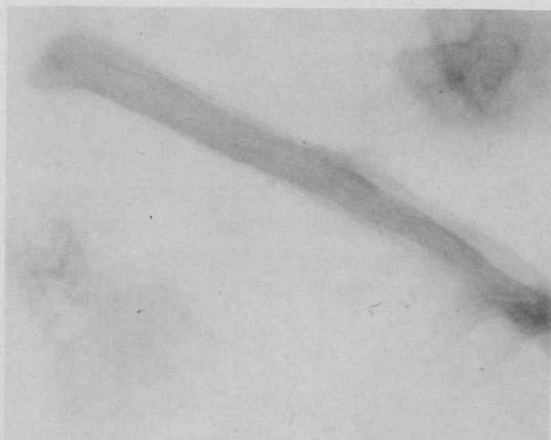
Рис. 5. Электронная микрофотография оссеина после 72-часовой щелочно-солевой обработки. Увеличение \times 75000
