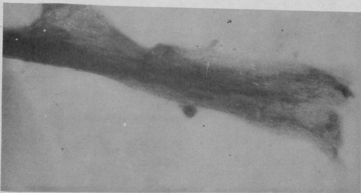
Рис. 6. Электронная микрофотография оссеина после 30-суточного зольения. Увеличение \times 75000
