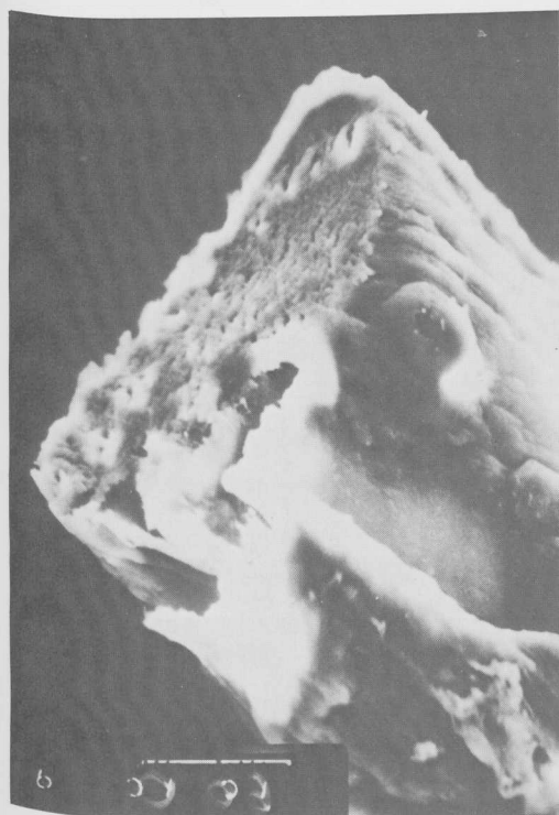
Рис.2. Микрофотография поперечного среза микроволокна. Кратность увеличения \times 600 .
