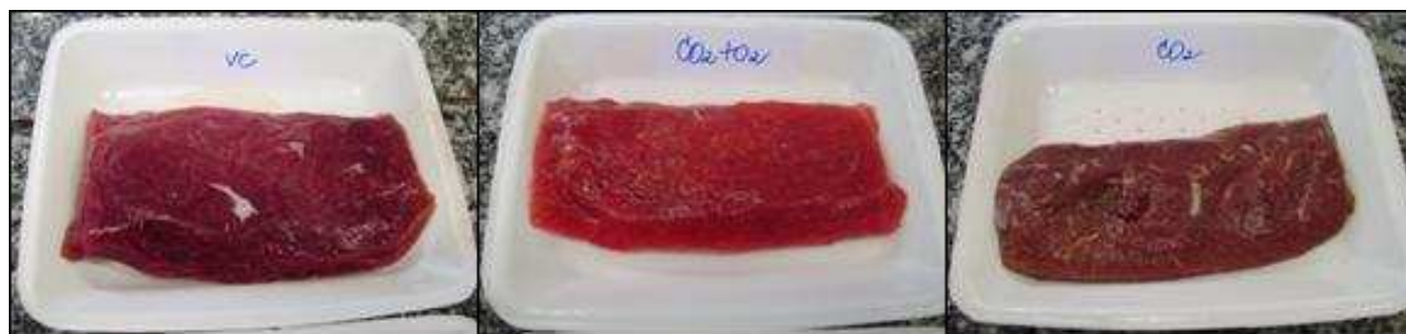
Fig. 1 - Lamb Longissimus lumborum packaged in different modified atmospheres: VC = Vacuum, O_2+CO_2 = 75% O_2 +25% CO_2 and CO_2 = 100% CO_2
